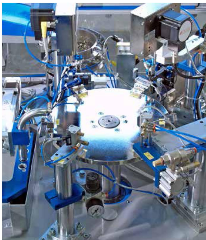
linea robotizzata montaggio, collaudo e taratura rubinetti gas per cucine
